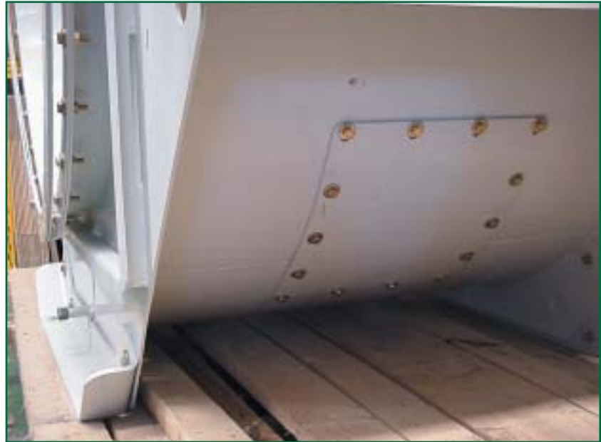
Dettaglio della portella di ispezione e del tappo di scarico condensa.
