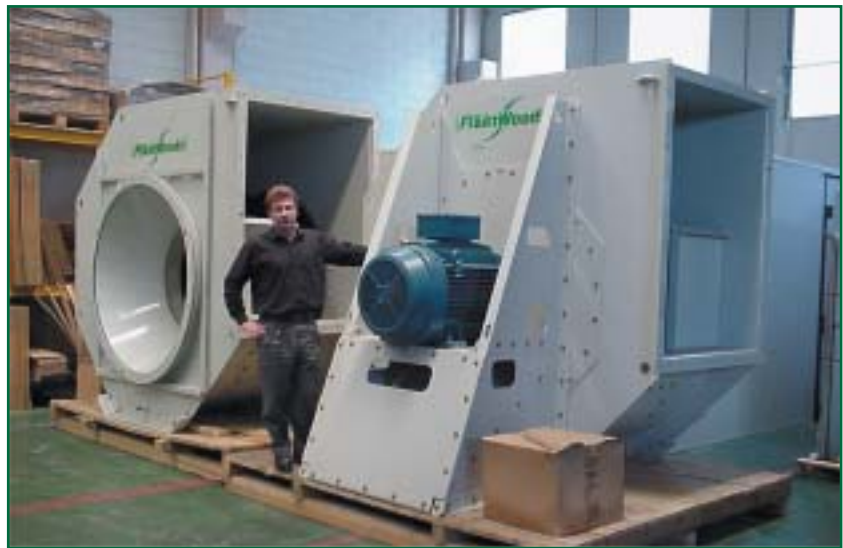
Ventilatori centrifughi direttamente accoppiati a motori elettrici da 37 kW.
