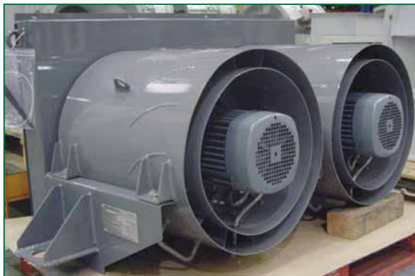
Coppia di ventilatori in parallelo per la ventilazione di radiatori dei motori di trazione.
