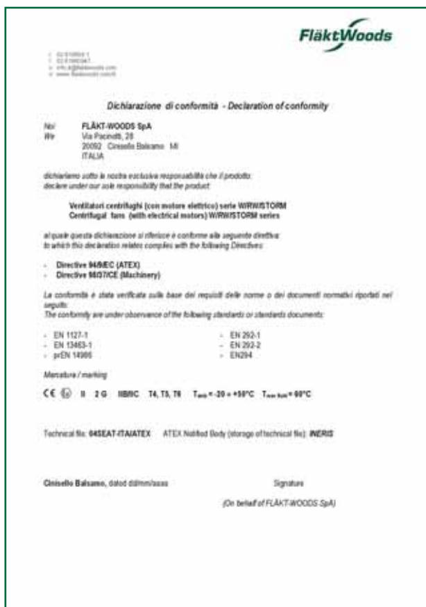
Figura 3b - Esempio di “Dichiarazione di Conformità” per ventilatori W, RW, STORM forniti con motore elettrico
